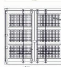
Estructura perforada para la circulación de aire en la zona del grupo generador y unidades exteriores de AVAC
